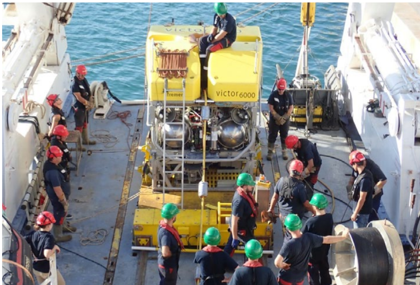
Opération de mise à l'eau de Victor 6000. Operazione di messa a mare del Victor 6000.
